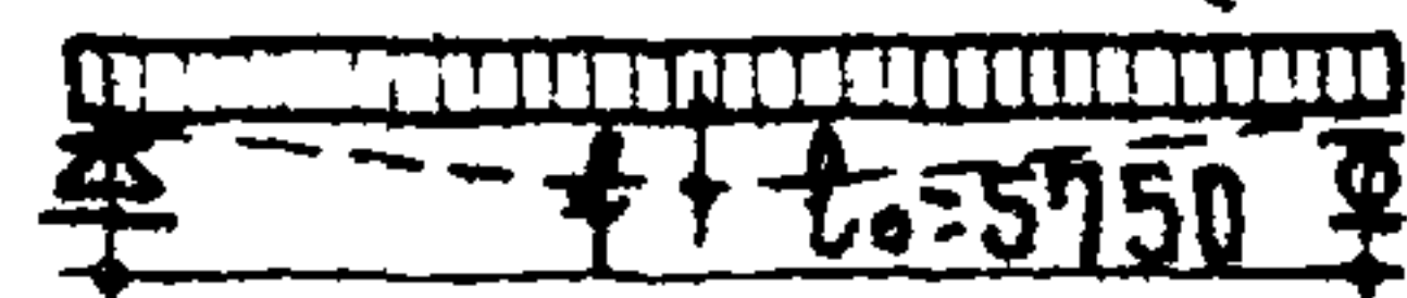
Схема при испытании (по ГОСТ 8829-58)
